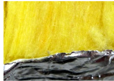
Abbildung 11: Faserstruktur von Mineralwolle (zieht Feuchtigkeit an)
