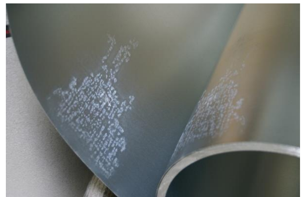
Weißrost an einem Blechcoil
