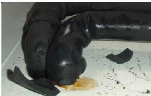
Abbildung 7: Stoffliche Schädigung durch Durchfeuchten
