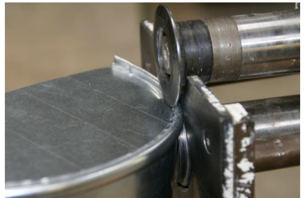
Schließen der Kastensicke mit der Sickenmaschine
