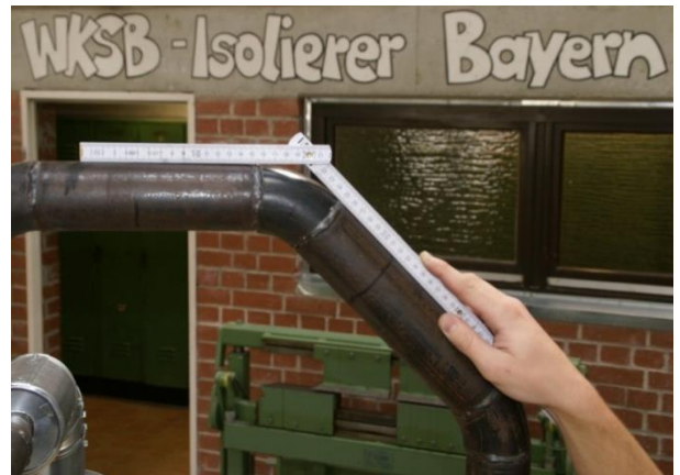
Abnehmen des Winkels von der Rohrleitung
