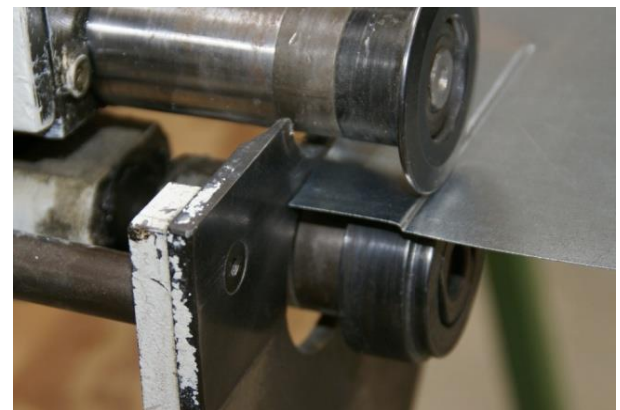
Durchsetzen bzw. Absetzen eines Bleches an der Sickenmaschine
