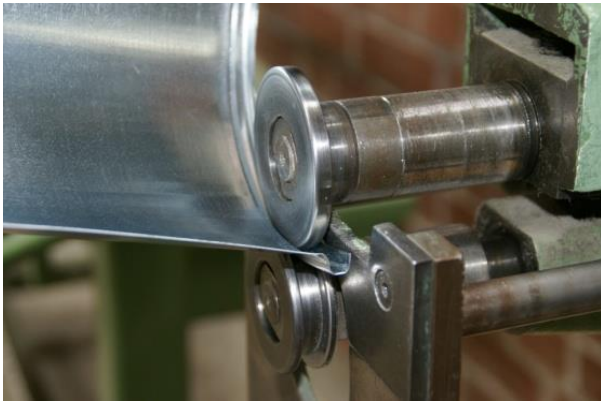
Herstellen einer Kastensicke
