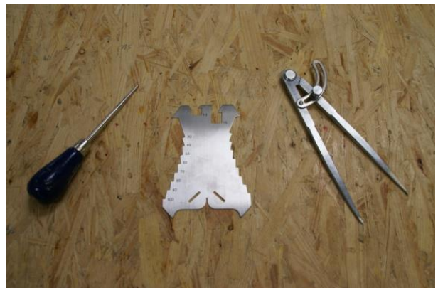
Reißnadel Anreißschablone Feststellzirkel (Hundt, Wuppertal)
