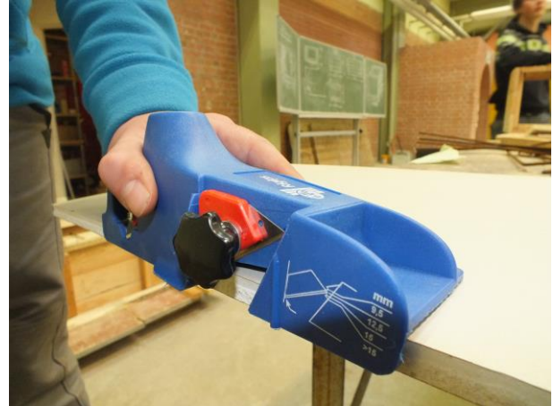
Nacharbeiten eines Plattenrandes
