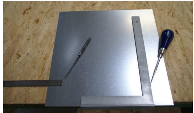
Anreißtechniken: Anreißen mit Meterrmaß und Anschlagwinkel
