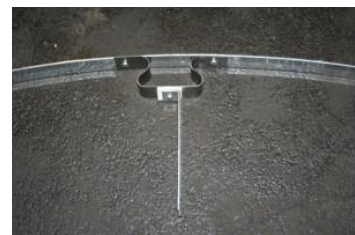
Abstandhalter mit Omegastegen gegen Vibrationen
